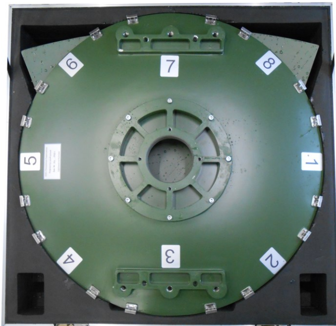
Рисунок 5 – Рекомендуемое расположение СЧ МАС-1,8 в кейсе №3
